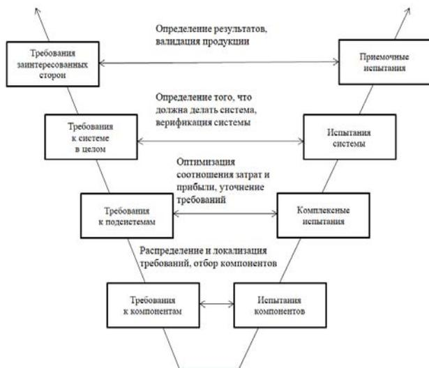
Рис. 1. Декомпозиция требования в виде V-модели.
