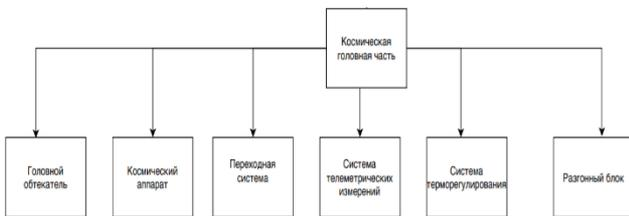
Рис.1. Граф космической головной части ракеты-носителя.
